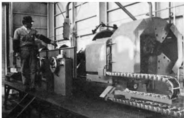
八戸内燃機工業協業組合で購入したクランクシャフト用円筒研削盤
