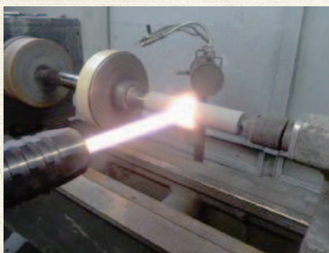
溶射による補修
