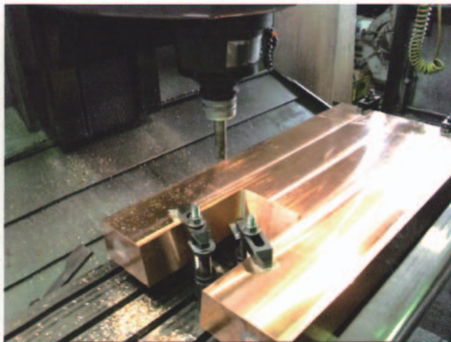
縦型NCフライス盤での銅材加工
