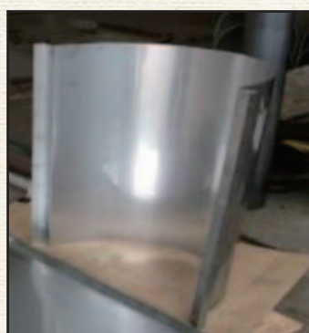
ステン板の曲げ加工
