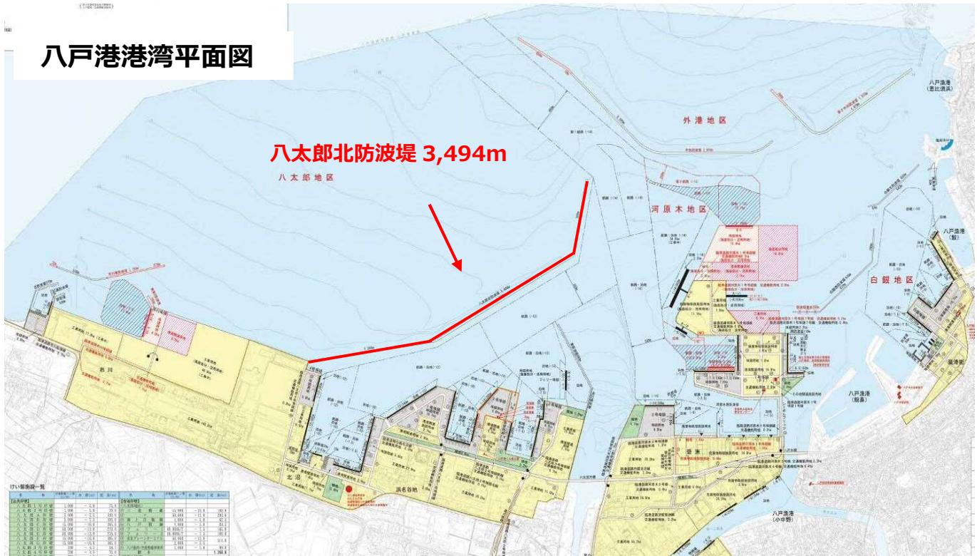
⑦低気圧や台風による高波が防波堤を超える頻度が多くなっており、船舶に影響を与えていた。八太郎北防波堤の嵩上げが第一希望。
